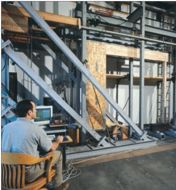
Esta prueba simula docenas de ciclos de cargas sísmicas laterales sobre la misma línea de pared. De esa manera los investigadores pueden determinar la idoneidad de distintos esquemas de apuntalamiento en función del desempeño sísmico, como extender la viga cabezal de glulam sobre la pared final angosta.
