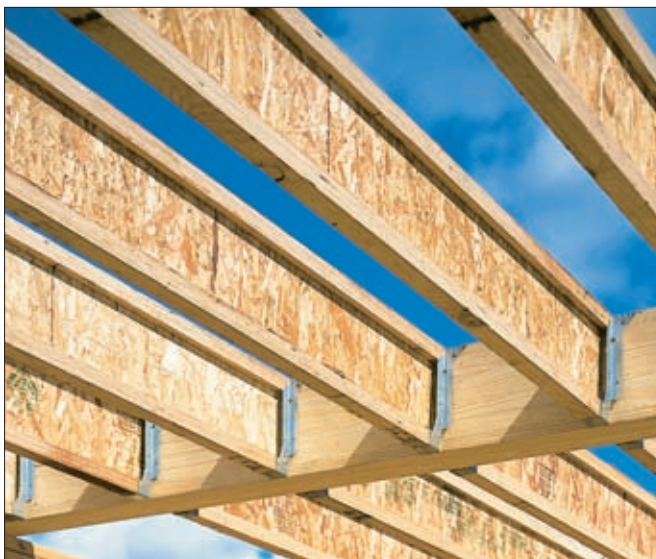
Las vigas compatibles con vigas I-joist de piso (IJC) se suministran en profundidades de 9-1/2", 11-7/8", 14" y 16".
